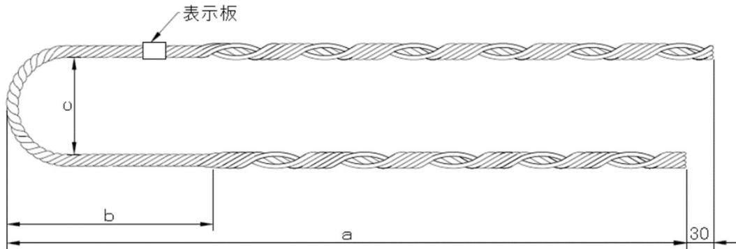
材質：JIS G 3506(硬鋼線材)、亜鉛めっき
