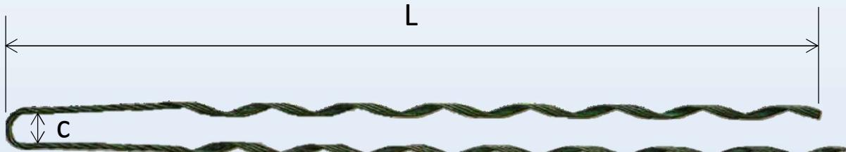
素線: JIS G 3506 (硬鋼線材)、亜鉛めつき
