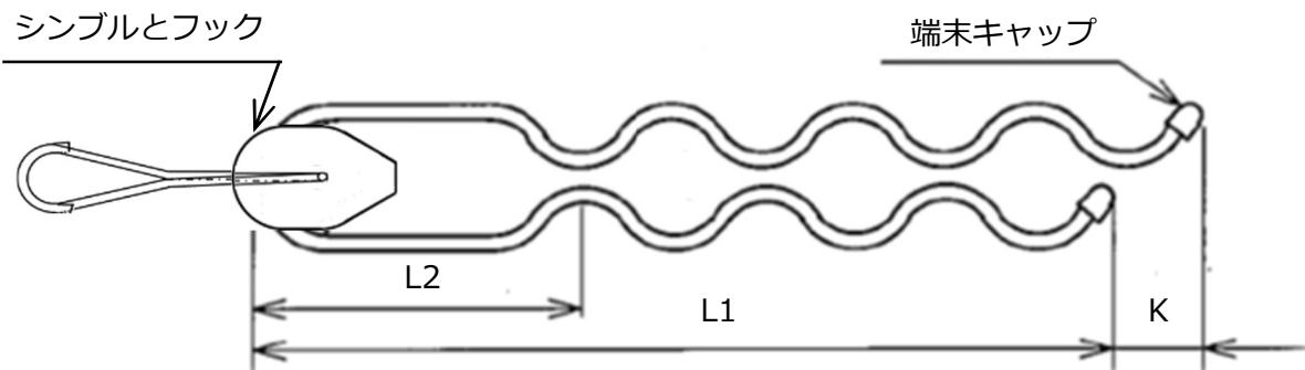
素線：JIS G 3506 (硬鋼線材)、亜鉛めっき
